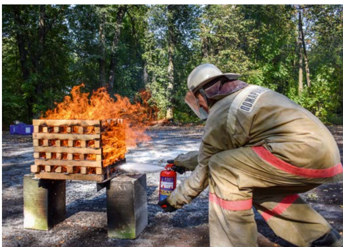
Тушение модельного очага класса 0,7А
