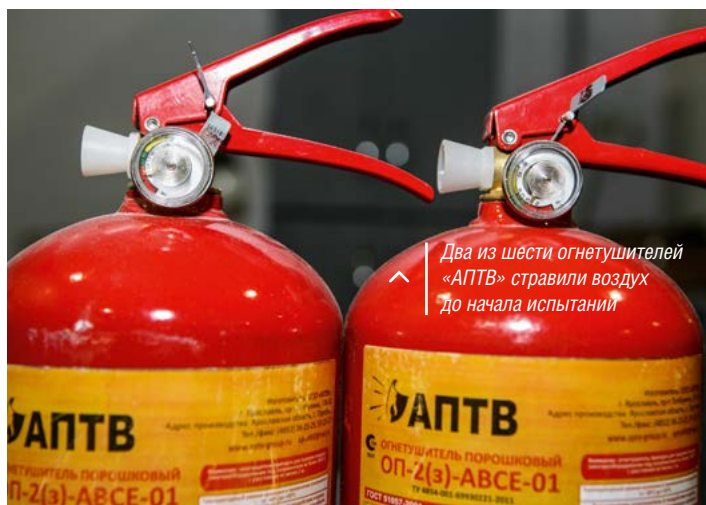
Зависшая стрелка манометра после выпуска огнетушителя
