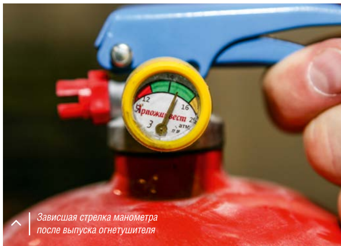
Два из шести огнетушителей «АПТВ» стравливали воздух до начала испытаний
