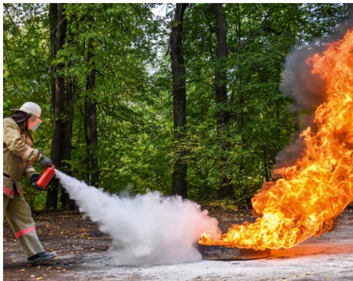
Поджог и тушение модельного очага класса 21В
