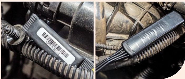
Цифровой иммобилайзер Iгла (слева) благодаря очень компактным размерам полностью упирается в кожу штатной проводки. Второе — большой аналоговый конкурент (справа) — остается снаружи
